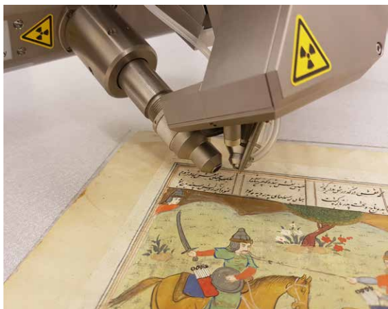
Analys av pigment på ett manuskript med röntgenfluorescens (XRF), som demonstrerades på ForskarFredag Gotland. Bild: Riksantikvarieämbetet
