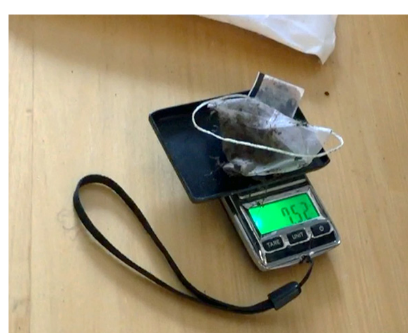
Tepåse vägs efter uppgrävning.
